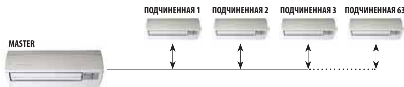
УПРАВЛЕНИЕ ВЕДУЩИЙ/ПОДЧИНЕННЫЙ ДО 64 БЛОКОВ НА ОБЩЕЕ РАССТОЯНИЕ ДО 1200 м
